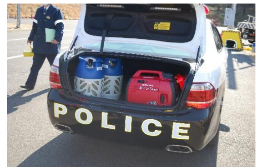
LPガス発電機搭載状況
